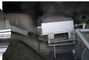
回転ドラムの傾きで処理時間を調節する。
