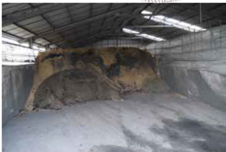
培土の基本素材は、浄水汚泥ともみ殻を混和して寝かせたもの。
